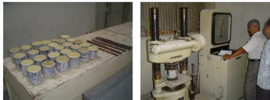
Pengujian Kuat Tekan Beton di Lab
