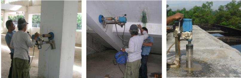
Pengambilan Benda Uji dengan Metode Core Drill
